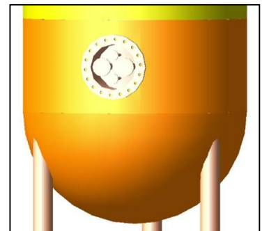
Example of a vertical LNG Vessel @ 10m 3
